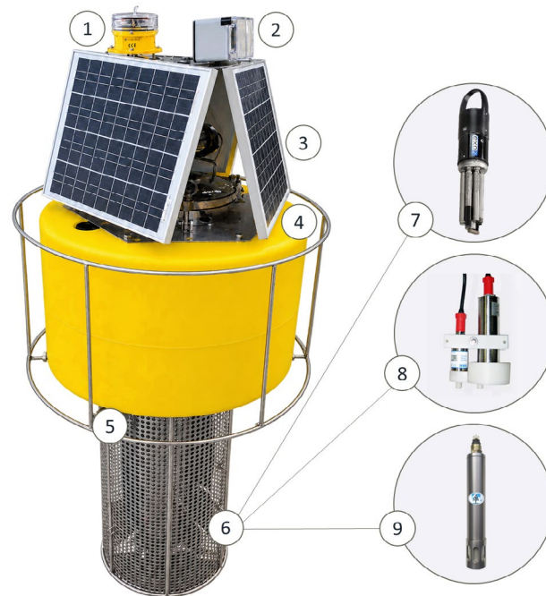
Рис. 2. Схема АБС: 1 – маяк; 2 – модуль управления и передачи данных; 3 – солнечные панели; 4 – плавучий корпус; 5 – защитная рама; 6 – защитный кожух датчиков; 7 – зонд EXO2s; 8 – датчик METS (с насосом SBE 5M); 9 – датчик АМТ.
