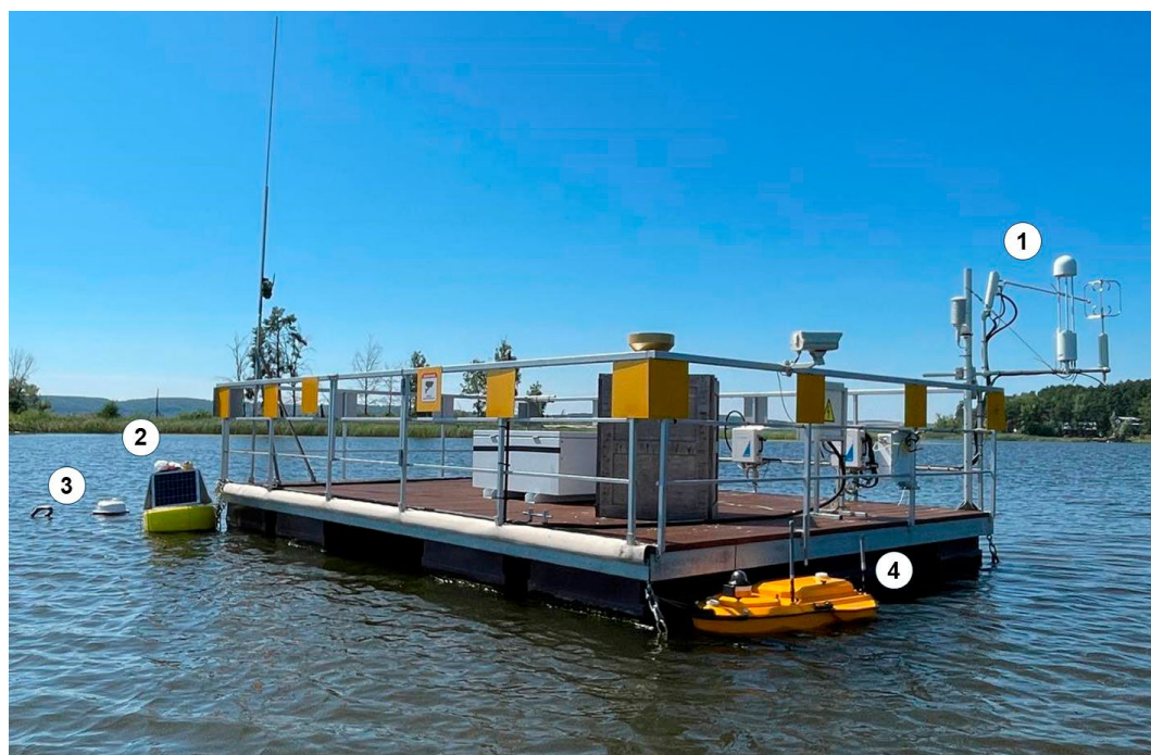
Рис. 7. Комплекс оборудования на водном участке карбонового полигона «Карбон – Поволжье»: 1 – система ТП на стационарно заякоренном понтоне; 2 – АБС; 3 – плавучие камеры; 4 – беспилотный надводный аппарат Apache.
