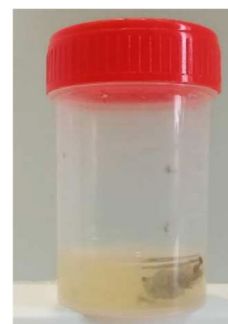
Рис.1. Внешний вид мицелий-подобной массы, образующейся в водных дисперсиях наночастиц ПВХ при 10-11°C (Концентрация ПВХ 328 мг/л, диаметр частиц 96 нм).
