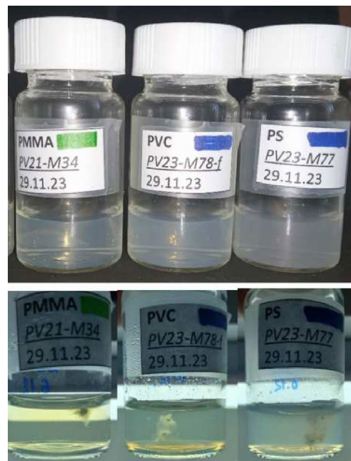
Рис.4. Фотографии дисперсий синтетических полимеров до (вверху) и после (внизу) посева гриба L. coprophilum и выдерживания в течение 76 дней при 10-11°C. Начальная концентрация наночастиц – 100 мг/л.
